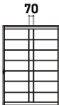
吹き寄せ障子
